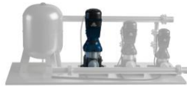
用水高峰期加，中泵无法单独满足需求时，大泵运行满足供水需求。
